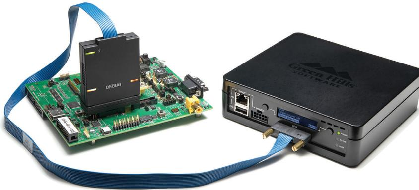
容量4GB、総帯域幅40Gbit/秒の高速トレースメモリを搭載するハードウェア・デバッグプローブ
